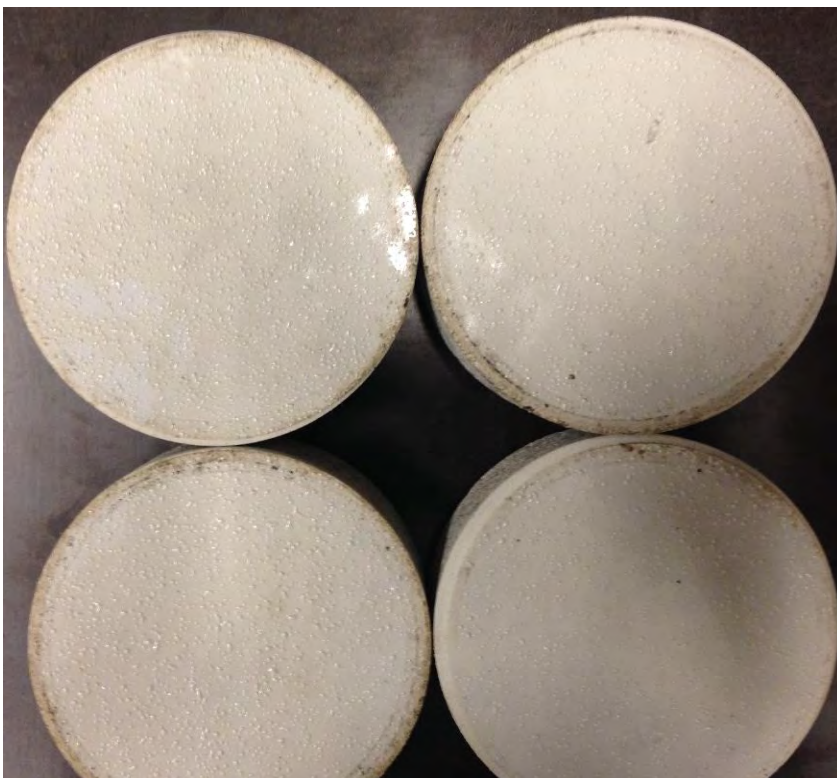
Figur 2.95 Polyurea – Micorea HS efter prøvning enligt Prall
