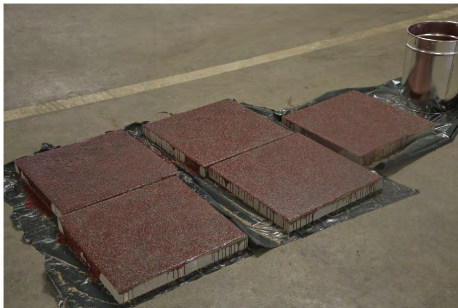
Figur 2.22 Provpplattor efter påfört Duracon membranlager med strö (Foto: Y Edwards)
