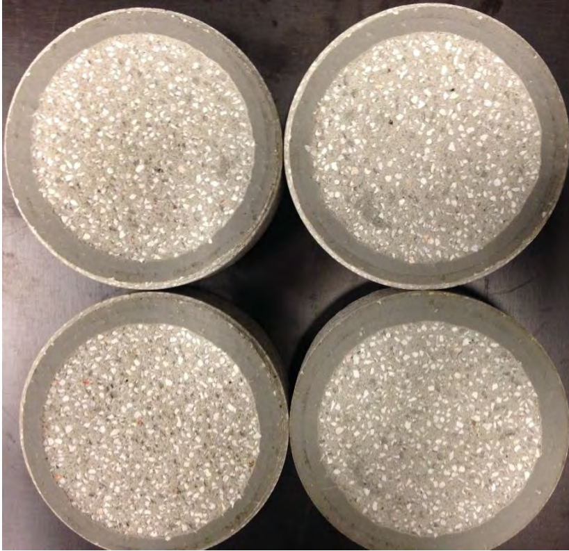
Figur 2.94 Polyuretan – Ucrete efter prøvning enligt Prall
