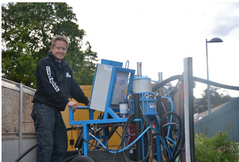
Figur 2.32 Aggregat för blandning av polyurea (fick placeras utanför garaget på grund av otillräcklig takhöjd vid garageinfarten) (Foto: Y Edwards)
