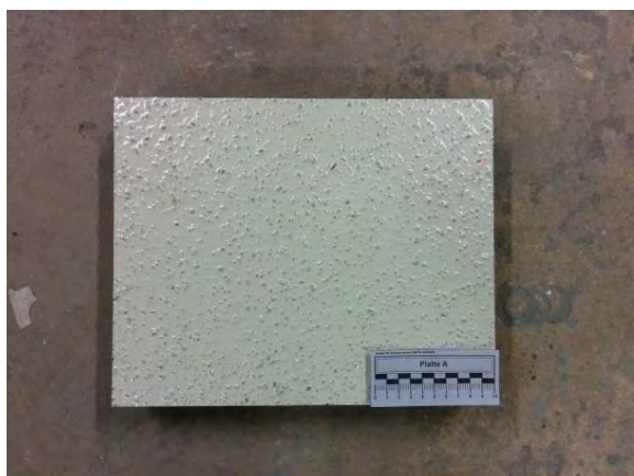
Figur 2.49 Polyuretan 2 StoCrete före och efter provning
