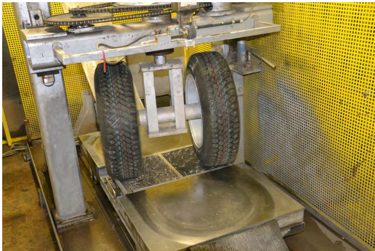
Figur 2.40 Utrustning för provning av Scuffing resistance, med dubbdäck (Foto: Y Edwards)
