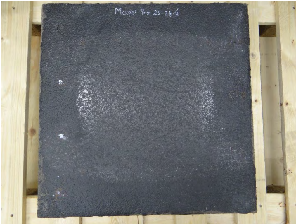
Figur 2.73 Akrylat – Map Pro efter prøvning enligt RWA
