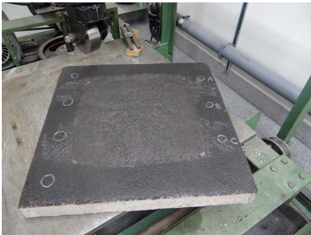
Figur 2.100 Akryl – Duracon efter prøvning enligt RWA
