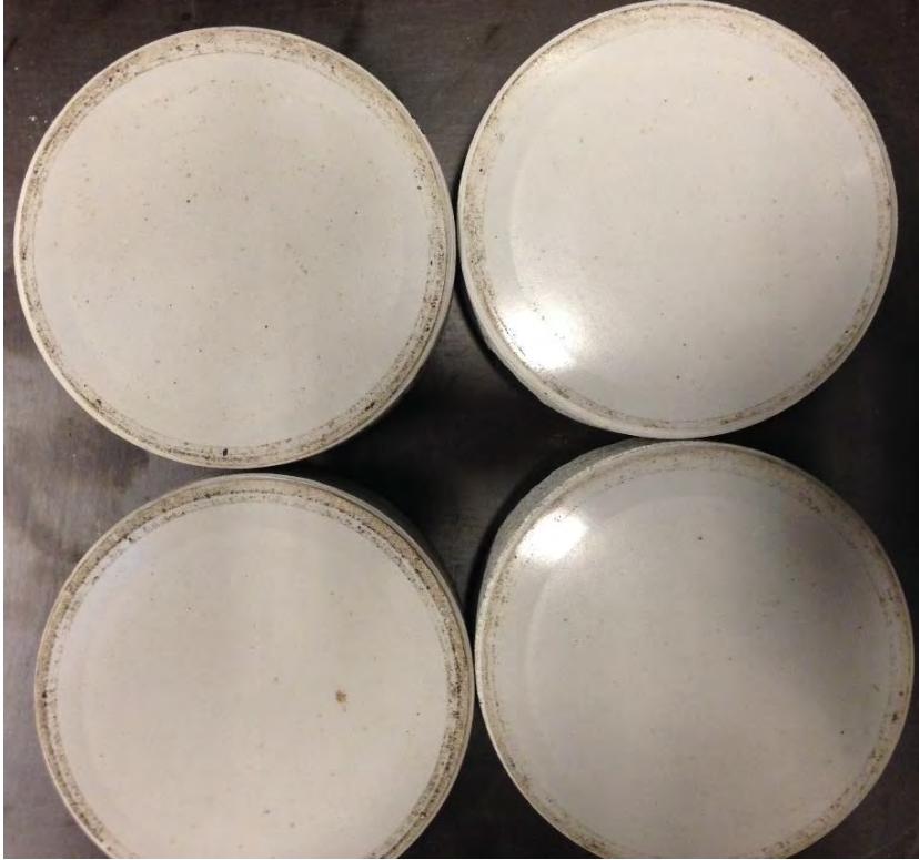
Figur 2.96 Epoxi – Micopox C-HD efter prøvning enligt Prall
