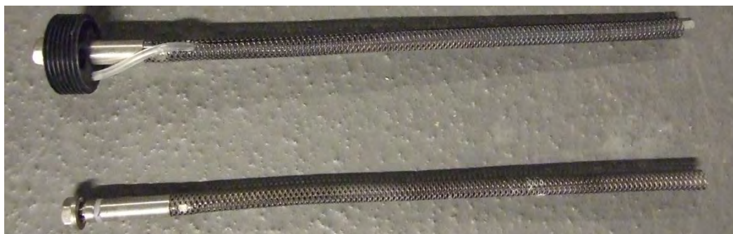
Figur 3.3 Instickselektrod av märket DurAnod 3 från Force. Den övre anoden används vid vertikal montering i innertak
