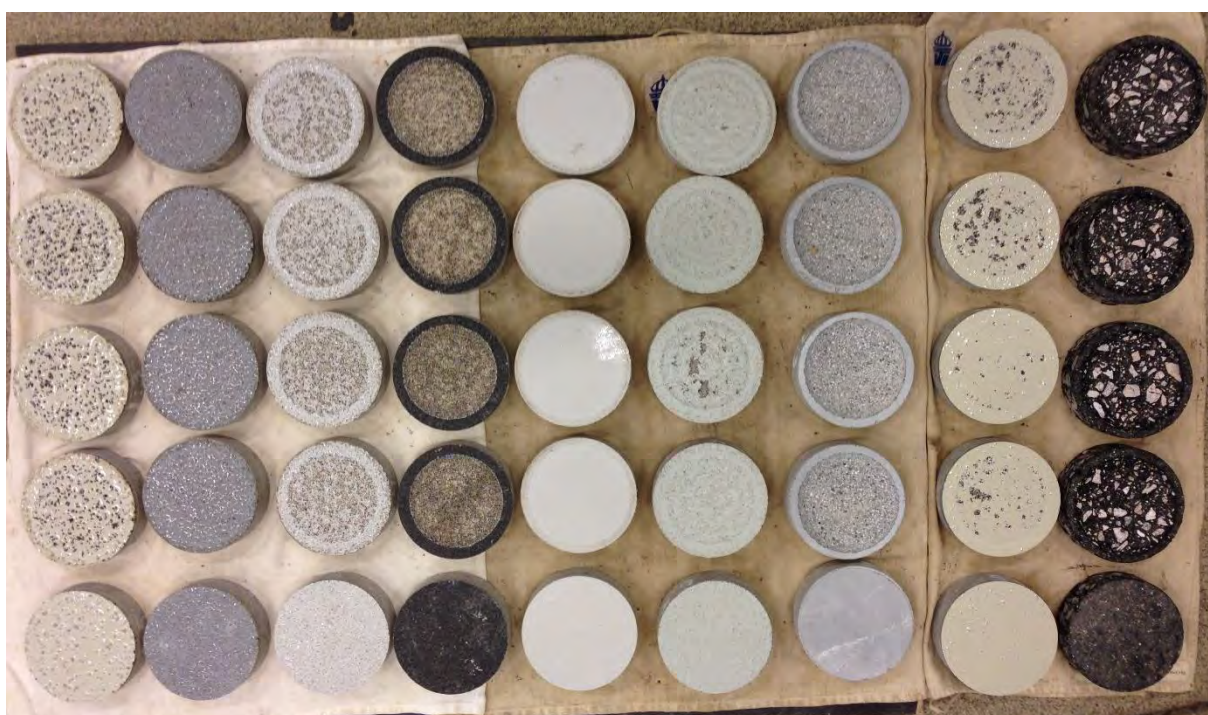
Figur 2.63 Samtliga system efter provning enligt Prall. Från vänster: StoCrete, Deckshield ID, Mapefloor PU, Map Pro, Micorea S3, Conideck 2255, Densit, Sikafloor 375 och PGJA. Understa raden visar provkroppar som inte testats.
