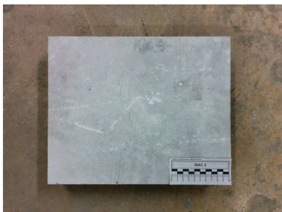
Figur 2.45 Hårdbetong Densit före och efter provning
