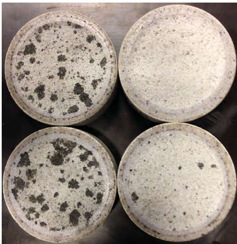
Figur 2.93 Akryl – Silikal efter provning enligt Prall
