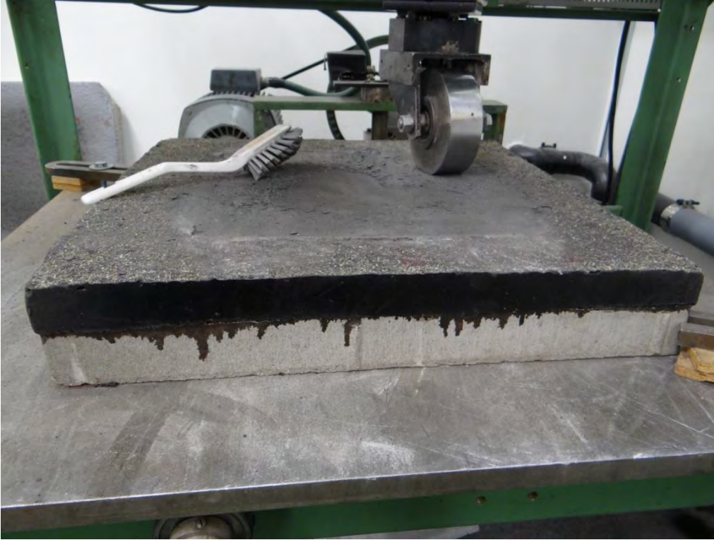
Figur 2.65 Gjutasfalt – PGJA efter provning enligt RWA
