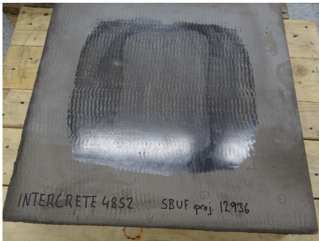
Figur 2.98 Hårdbetong – Intercrete efter provning enligt RWA
