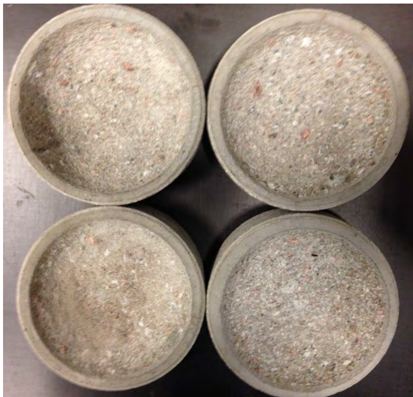
Figur 2.90 Hårdbetong - Intercrete efter provning enligt Prall
