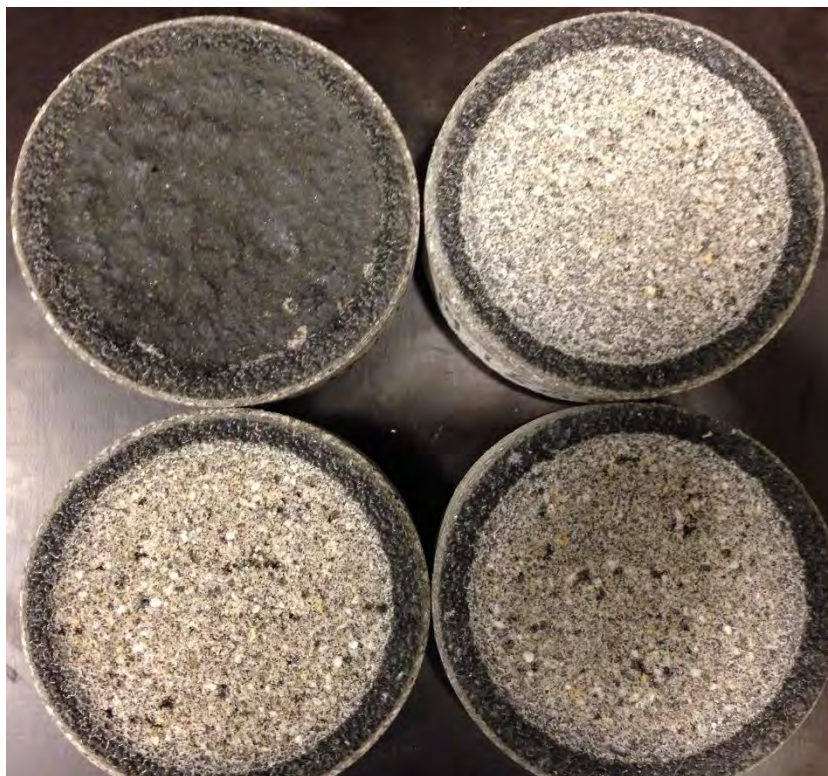
Figur 2.92 Akryl – Duracon efter provning enligt Prall (Stopp uppstod i vattenflödet för ett av proven, men det har inte påverkat resultatet)
