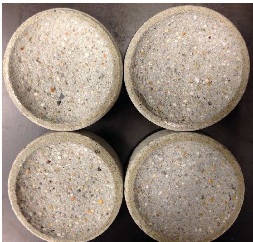
Figur 2.91 Hårdbetong – Mastertop efter provning enligt Prall
